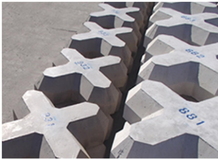
消波根固ブロック
